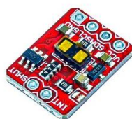
شكل (8) : حساس VL53LXX الليزري
