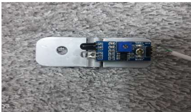
الشكل (3) جهاز حساس للأشعة تحت الحمراء والمثبت على رسغ اليد
