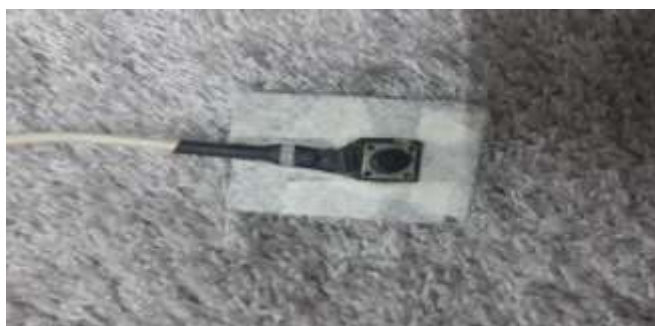
الشكل (4) يوضح جهاز متحسس للتشغيل والإطفاء
